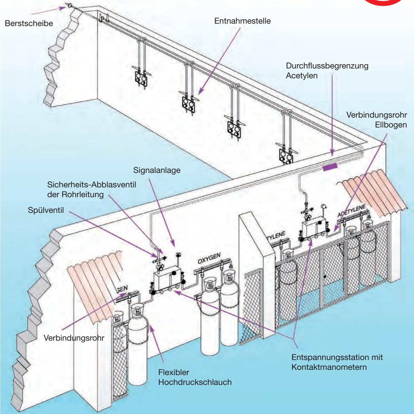
Bei der Installation von Gasversorgungs-Systemen und den damit verbundenen Rohrleitungsanlagen sind einschlägige Richtlinien und Technische Regeln wie z.B. Druckgeräterichtlinie PED 97/23/EG, TRAC, UVV, DIN, EN, ISO zu beachten.
