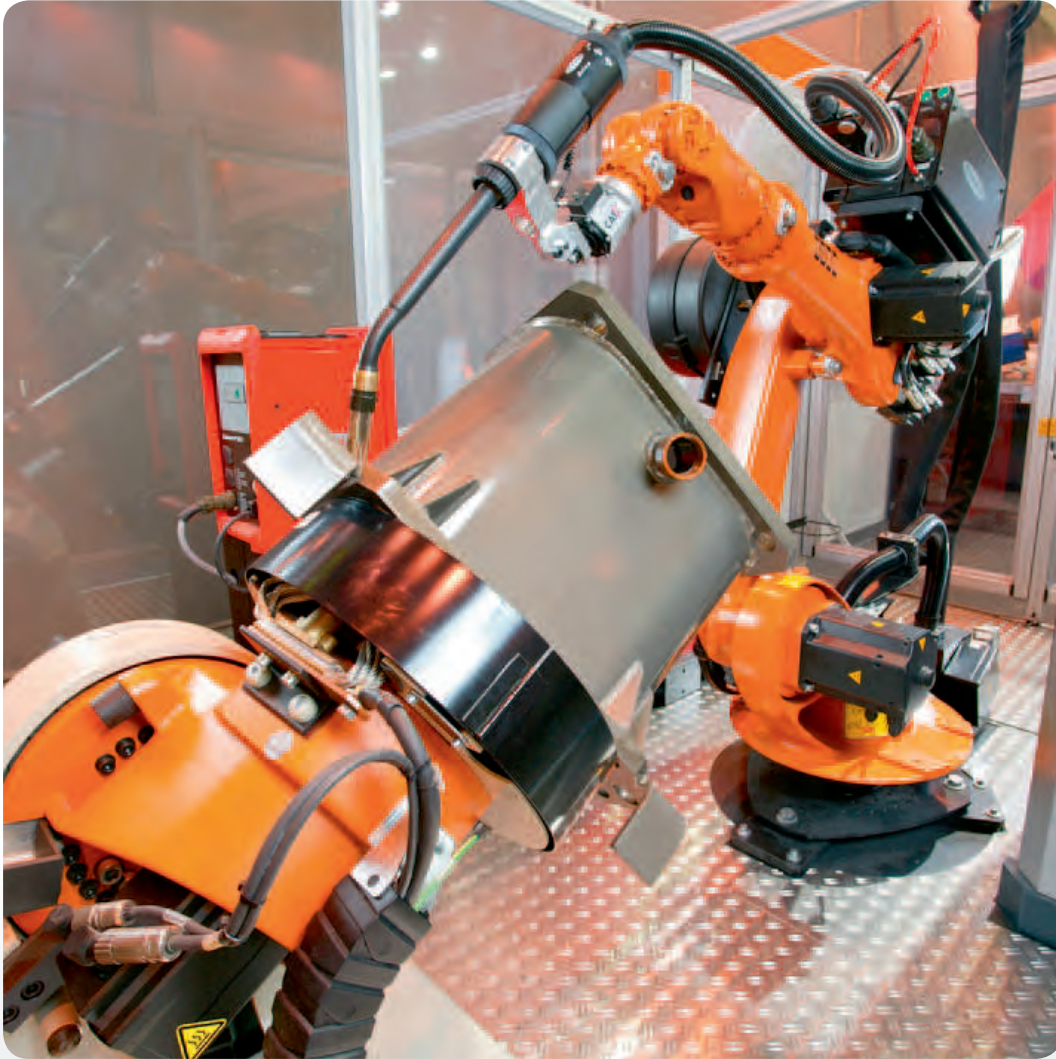
Roboter-MAG-Schweißen von Druckbehältern mit frei programmierbarem Drehkip-Positionierer
