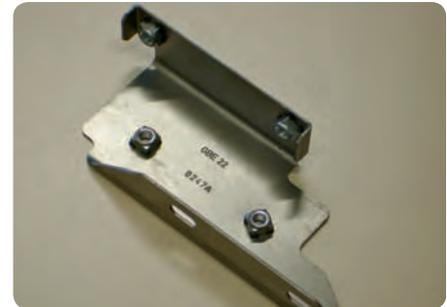
Um beschichtete Bleche und Bauteile (verzinkt, aluminiert usw.) zu schweißen haben sich Verfahren mit Invertertechnik durchgesetzt. Dazu gehört das Mittelfrequenz(MF)-Schweißen und die 10 kHz-Technik. Bei diesen Verfahren wird mittels Inverter der Strom mit höherer Frequenz getaktet und gleichgerichtet. Die dabei erzielte, höhere Leistungsdichte verkürzt den Schweißprozess, macht ihn exakter und besser regelbar.
